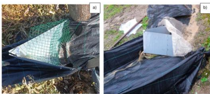
Figura 4. Fotografias de (a) armadilha de sedimentos com canal de Parshall modificado e sensor de pressão instalados e (b) armadilha em funcionamento durante um evento de precipitação.
