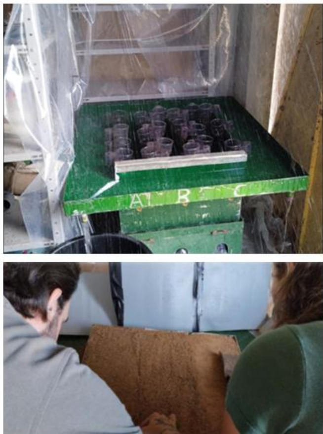
Figura 2. Calibração da intensidade do simulador de chuva, utilizando copos graduados (acima), e preparação do talhão (abaixo).
