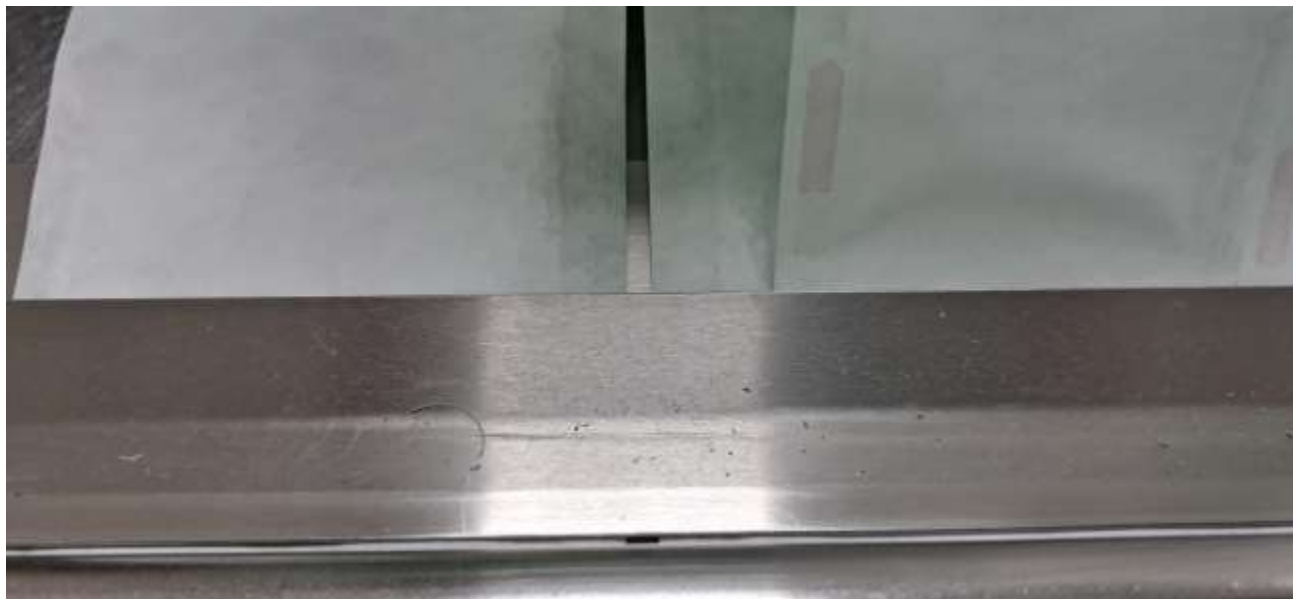
Maquina de Corte de Manga – cheia de Pó e resíduos (não foi limpa no inicio do turno) A utilizar/cortar as mangas alto risco de transferência de resíduos para a manga
