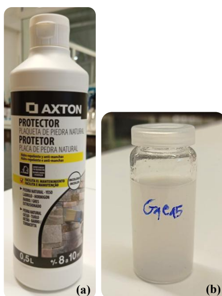
Figura 39: Revestimento hidrofóbico comercial Protetor Placa de Pedra Natural AXTON (a). Vial de um dos revestimentos sintetizados [G1(COOH)-C15] em estado líquido (b). As imagens não estão representadas à escala
