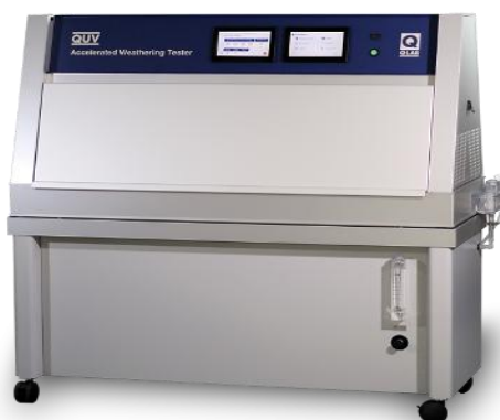
Figura 44: Câmara climática QUV-Accelerated Weathering Tester utilizada nos ensaios de envelhecimento acelerado para análise do desempenho dos revestimentos sintetizados
