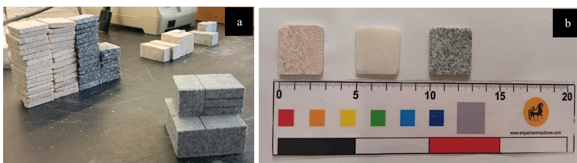
Figura 38: Preparação dos provetes em blocos de 3 \times 3 \times 0.4 cm com recurso a uma serra de corte (a).
