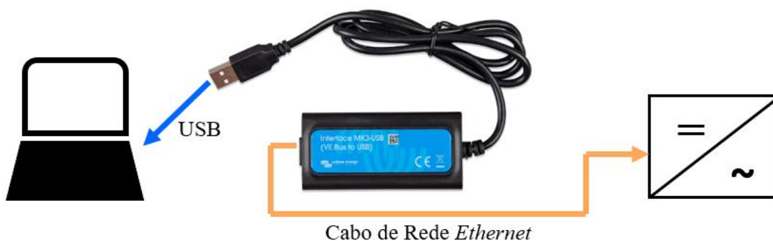
Figura 51 - Esquema de ligação para programação dos inversores
