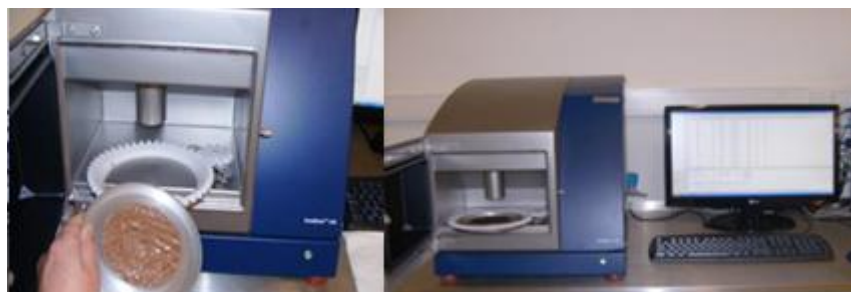
Figura 9 - Analisador automático para determinação de percentagem de gordura, humidade e acidez em pasta de azeitona
