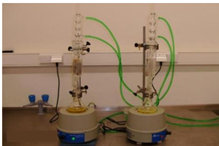
Figura 7 - Aparelho Soxhlet e balão para extração do óleo da pasta de azeitona.
