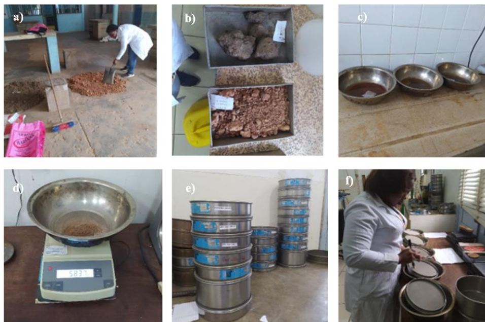
Figura 4. Realização dos ensaios de laboratório no LEM. a) Preparação das amostras para o ensaio. b) Secagem das amostras na estufa a uma temperatura de 110 °C durante 24 horas. c) Imersão das amostras na água durante 24 horas. d) Pesagem das amostras após a lavagem e secagem na estufa. e) Série de peneiros utilizados para a peneiração das amostras de solo. f) Processo de separação do material retido nos peneiros para posterior pesagem.
