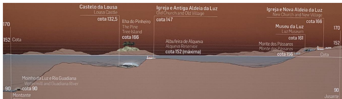
Figura 23. Imagem representativa da cota original do Rio Guadiana e a nova cota depois da construção da barragem (EDIA, 2006)
