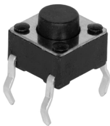
Figura 34 - À esquerda um botão NA para breadboard; à direita o esquema de ligação interno.
