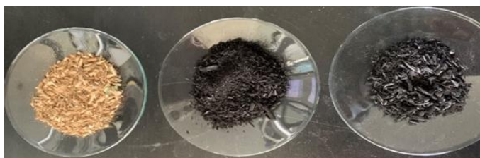
Figura 2: Aspeto das amostras utilizadas, antes de ativadas. CMC bruto, CMC carbonizado (100%) e CMC+CDR carbonizado (90-10%).
