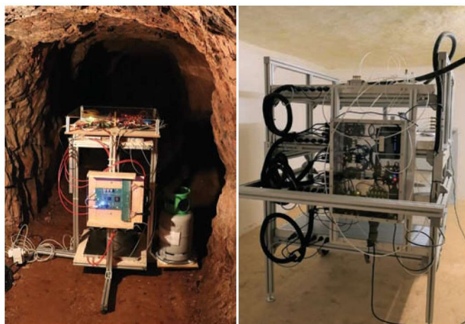
Figura 5 - À esquerda, MiniMu, protótipo usado para testar o equipamento nas condições da mina e para divulgação do projeto nas visitas ao Lousal; à direita, CorePix, telescópio de muões com quatro RPCs, a operar no interior do paiol 4 da Galeria Waldemar.
