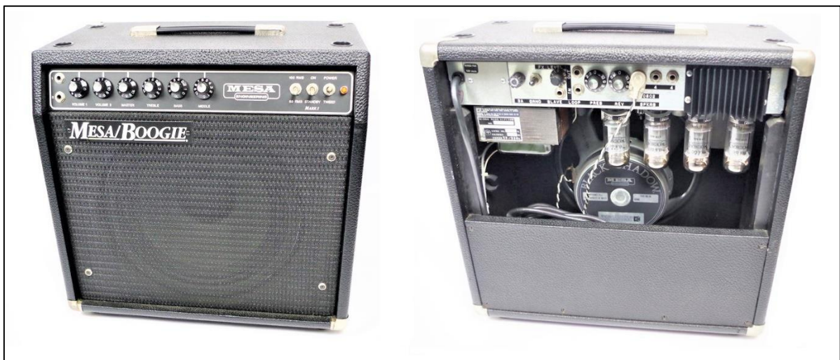
Figura 19: Amplificador valvulado – Mesa Boogie Mark I Reissue – painel frontal (à esquerda) e painel traseiro onde se veem as válvulas (à direita), in https://www.mesaboogie.com/amplifiers/
