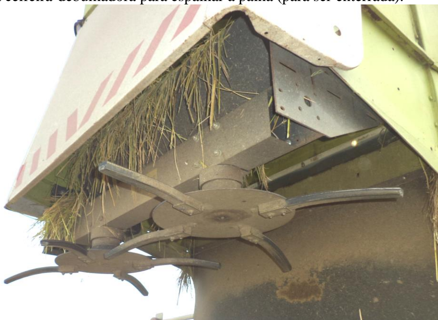
Pormenor de um espalhador de palha. Herdade da Comporta – Visita de estudo 2013
