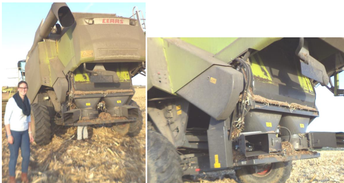
Conjunto de triturador de palha ( straw chopper ), impulsos e saídas oscilantes. Herdade do Monte-Novo – Visita de estudo 2016
