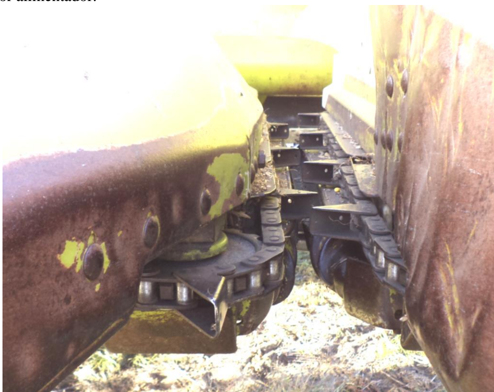
Vista de frente do mecanismo de colheita de uma linha de milho, sendo visível a correntes transportadoras. Visita de estudo à Herdade das Lages Grandes – S. M. Machede - 2012
