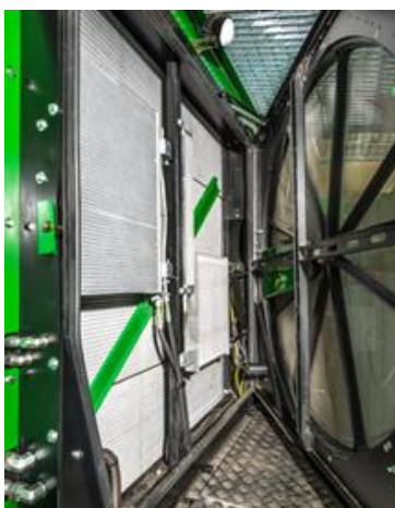
Dado o tipo de trabalho do CF, deve haver um especial cuidado na limpeza do filtro de ar – Herdade do Casão (TeAM 2016)
