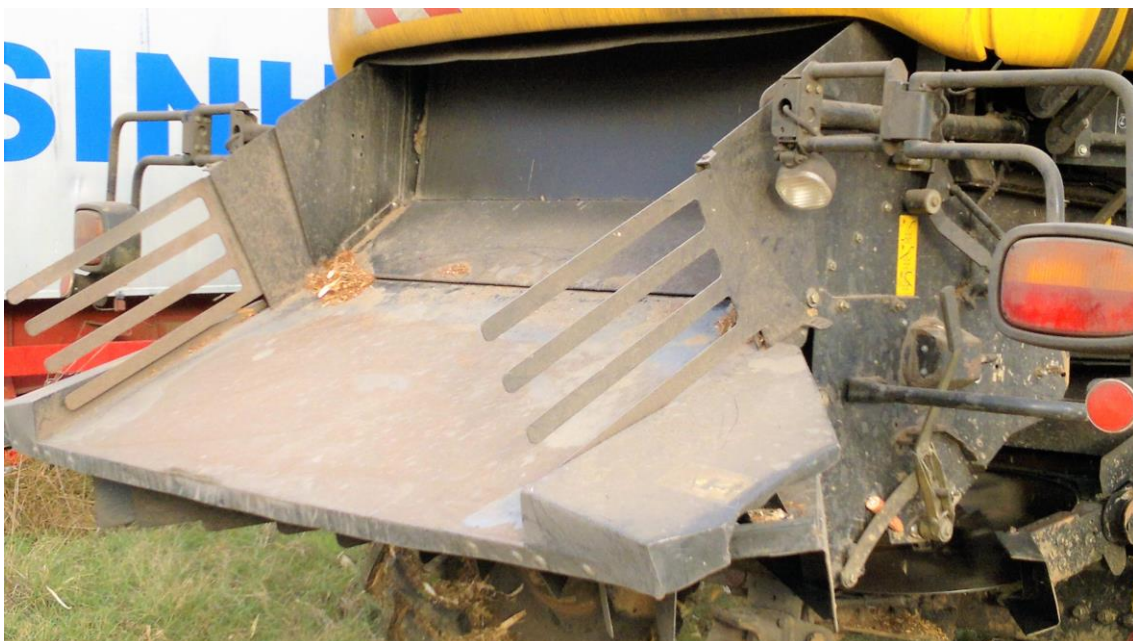
Saída de palha para cordão. Herdade da Mencoca, Montoito, 2018
