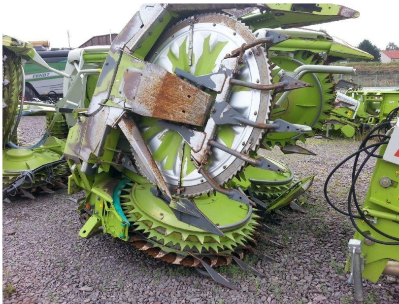
Posição de transporte da frente rotativa Claas. Notar o disco de corte.
