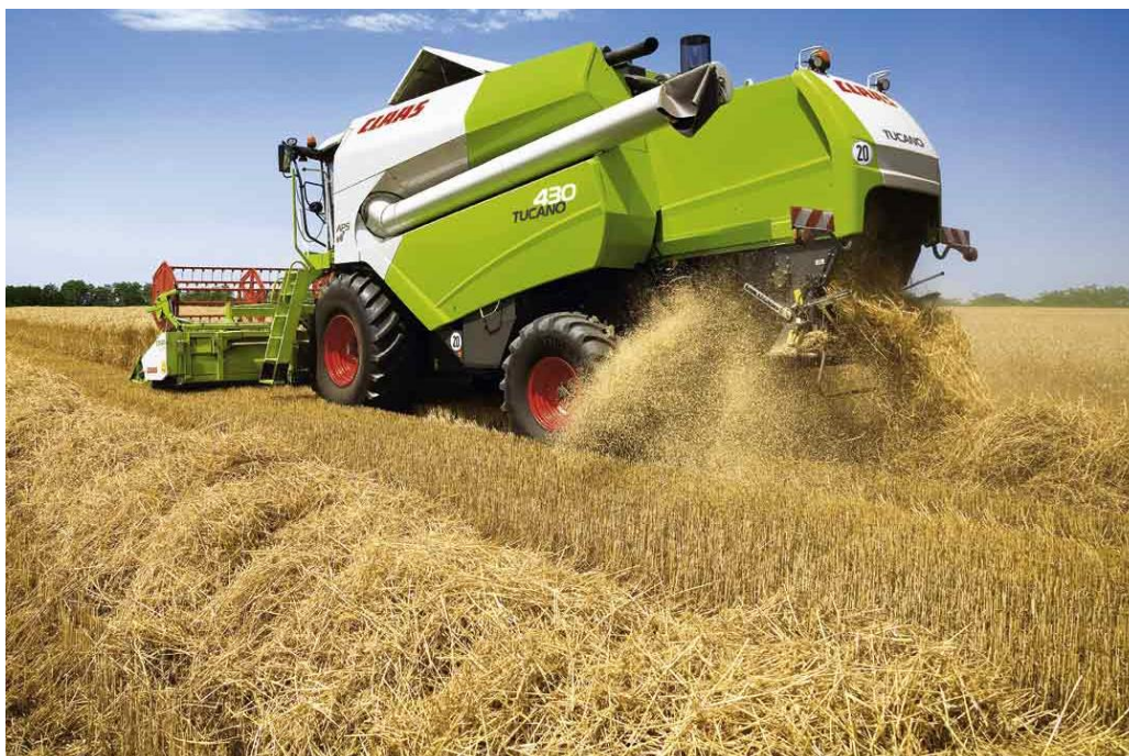
Palha encordoada e espalhamento lateral da moinha
