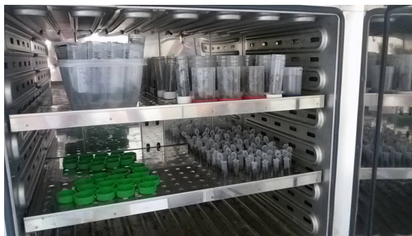
II.20 - Amostras colocadas na estufa a 50°C para a secagem dos dejetos
