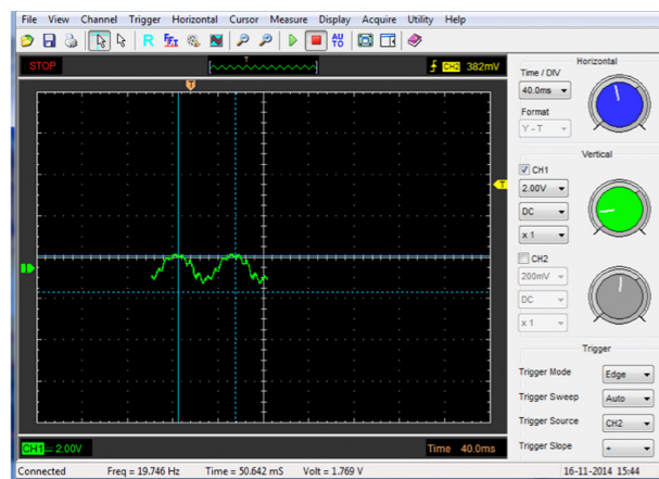
Figura 44 - Fotografia do monitor do osciloscópio com a frequência de 19.746Hz captada pelo piezo , após indução de 2.2 V no Motor 4. O registo do consumo de corrente elétrica foi de 0.04A.
