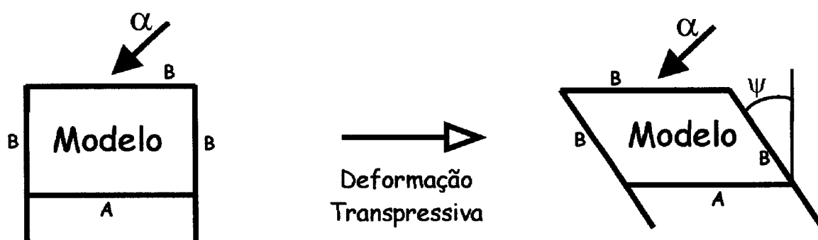
Figura 59 – Esquema no plano horizontal da prensa utilizada para induzir ao modelo uma deformação transpressiva. À esquerda vê-se o modelo antes da deformação e à direita o modelo depois de deformado com tensões transpressivas.
