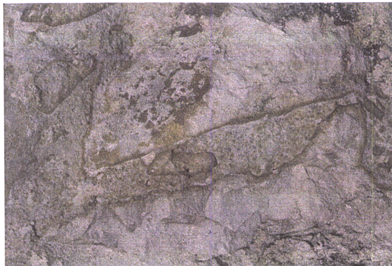
Fig. 5.2 – Calcário de estrutura heterogénea. Manchas amarelas, de tonalidade mais ou menos acentuada. 1996.
