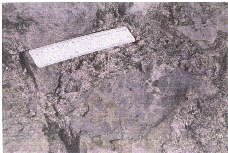
Fig. 5.3 - Calcário de estrutura heterogénea. Manchas cinzentas, de tonalidade mais ou menos acentuada. 1996.
