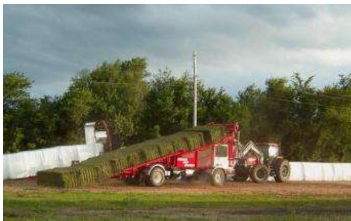
Fig.56 – Enrolamento de grandes fardos paralelepípedicos “em linha”
