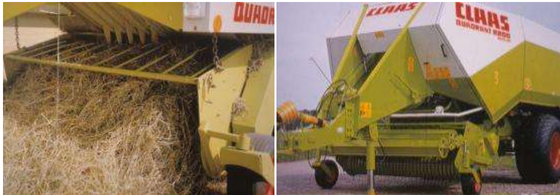
Fig.37 - “Pick-up” com calca feno convencional de dentes, e com um sistema de rolos.
