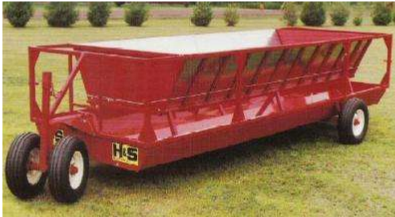
Fig.67 - Comedouros/transportadores de fardos
