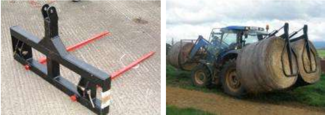
Fig.12 - Mecanismo de prensão de fardos, instalado na frente e/ou na traseira do tractor
