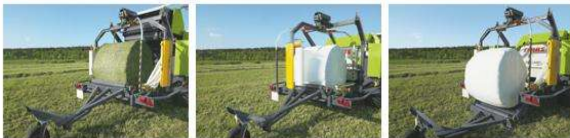
Fig. 32 - Enfardadeiras de grandes fardos cilíndricos com enrolamento do fardo em manga plástica
