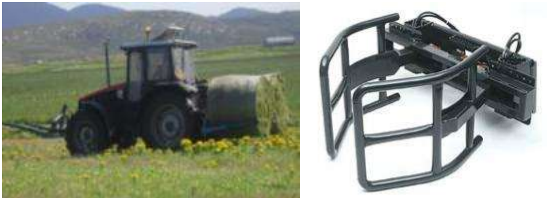
Fig.13 - Mecanismos de prensão de fardos, instalados na frente ou na traseira do tractor
