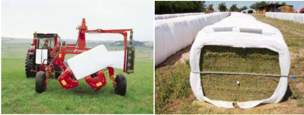
Fig.59 – Os fardos devem ser enrolados em plástico, logo após enfardados com plástico de boa qualidade.
