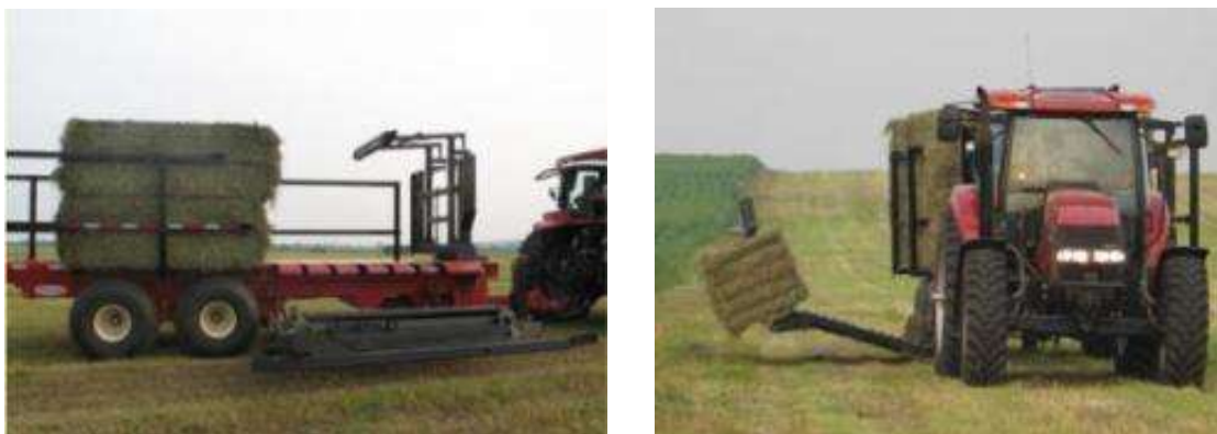
Fig.49 - Reboques auto carregadores de grandes fardos paralelepípedicos
