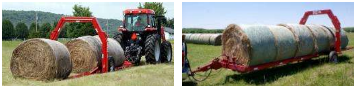
Fig.19 - Plataforma autocarregadora sem braço elevador de fardos
