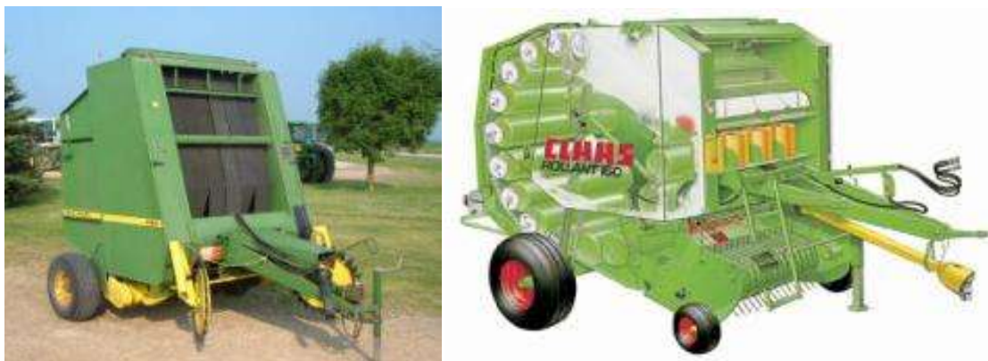
Fig. 4 - Enfardadeiras de grandes fardos cilíndricos de correias planas, e de rolos de aço
