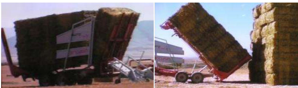
Fig.50 - Reboques auto carregadores de grandes fardos paralelepípedicos
