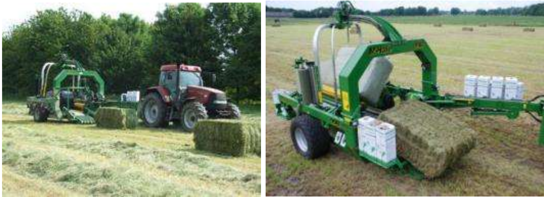
Fig.54 – Máquinas “auto enroladoras” de grandes fardos paralelepípedicos
