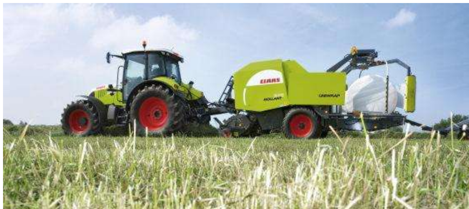
Fig. 31 - Enfardadeiras de grandes fardos cilíndricos com enrolamento do fardo em manga plástica
