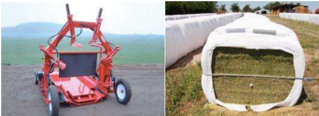
Fig.55 – Enrolador de grandes fardos paralelepípedicos “em linha”
