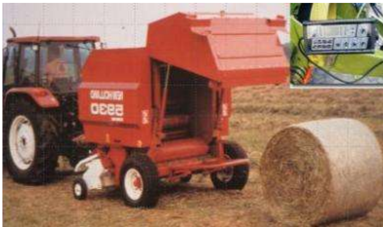
Fig. 7- Abertura da plataforma traseira da máquina e saída do fardo em queda para o solo
