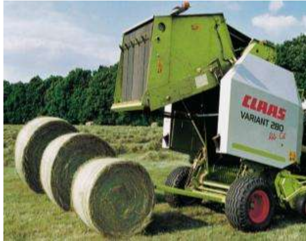
Fig. 5 – Enfardadeira de grandes fardos cilíndricos de câmara móvel
