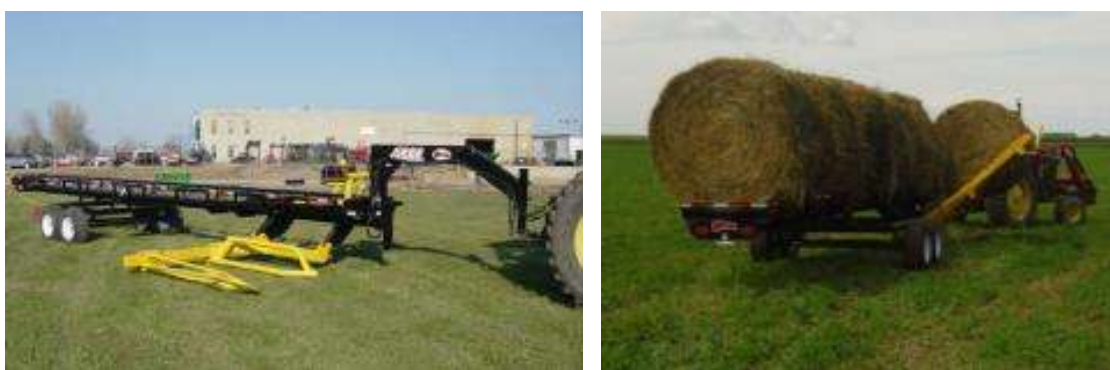
Fig.17 - Plataforma autocarregadora de fardos com braço lateral elevador de fardos
