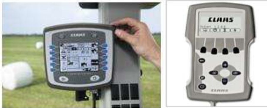
Fig.33 – Comunicador e unidade de controlo do enrolamento
