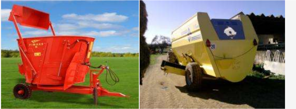
Fig.70 - Semi-reboques misturadores/distribuidores, vulgarmente conhecidos por “unifeed”
