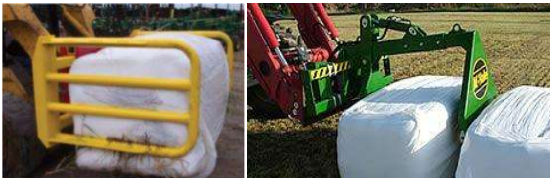
Fig.58 – Carregadores de grandes fardos paralelepípedicos envolvidos em plástico
