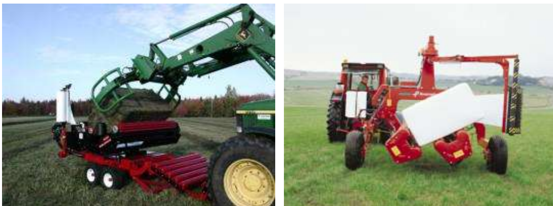
Fig.53 – Plataformas de enrolamento individual de grandes fardos paralelepípedicos
