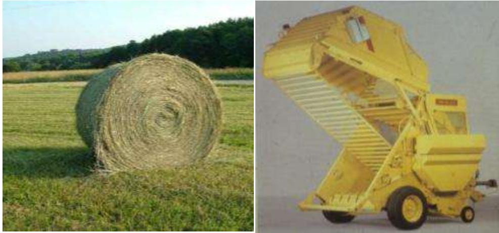
Fig. 8 - Fardos com faces densas e lisas obtidos com regulação da tensão,
