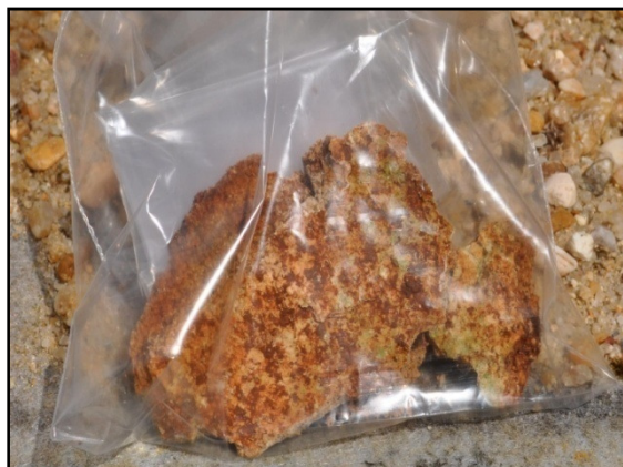
Figura 13 - Amostra 7 – Argamassa da estrutura em taipa
