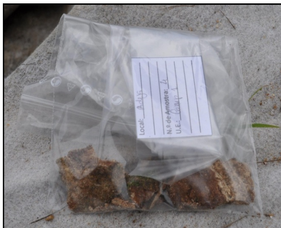
Figura 8 - Amostra 4 – Argamassa da adega, compartimento XII – (Programa do Castelo - 2011)
