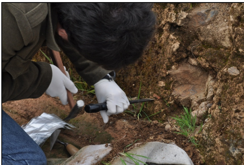
Figura 9 – Local de recolha de Amostras de Argamassa da adega
