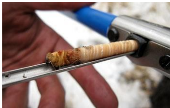
Figura 7- Pormenor de uma amostra de madeira em que se identifica a secção compacta de cor clara do sapwood e uma secção exterior mais escura da casca (o heartwood não é identificável).
