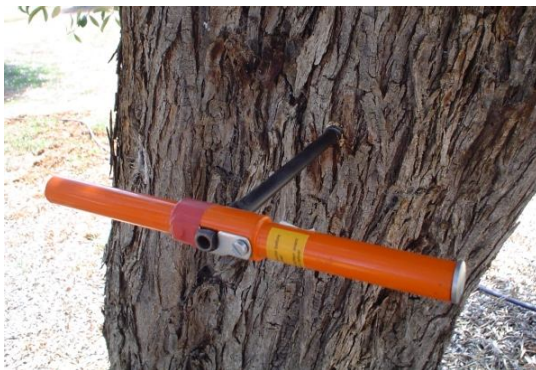
Figura 6- processo de extração de uma amostra de madeira com uma verruma na face de um tronco de oliveira.
