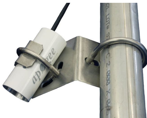
Figura 11- Radiômetro de infravermelhos Apogee Instruments, Inc. , UT,EUA mod. SI-111 instalado num poste sobre a copa.
