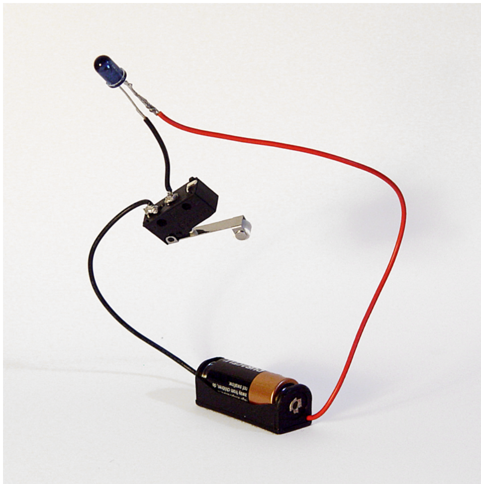
Figura 4.2: Esquema para construção de uma caneta de LED
