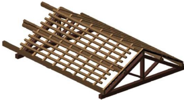
Figura 4.2 - Cobertura em asnas de madeira.
