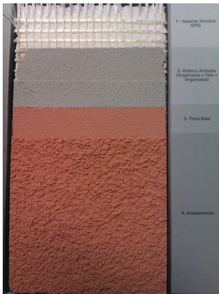
Figura 5.9 - Amostra da constituição do sistema de ETICS.
