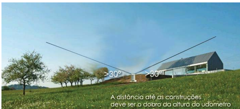
Figura 4.11 Diretivas para a localização de uma estação udométrica.
