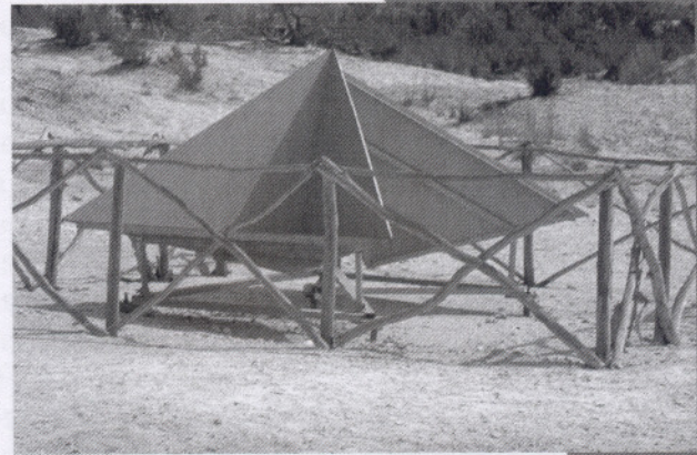
Cone reflector de equipamento radar instalado no satélite ESR-1 de modo a controlar variações da superfície do solo; Sulfatara, Nápoles, Itália (fonte: CCVE).
