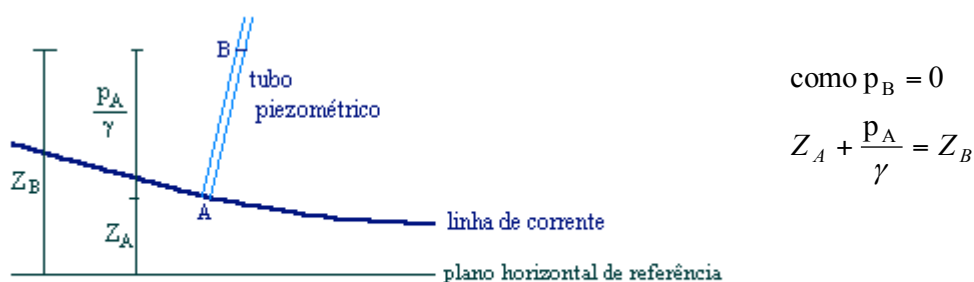
Figura 4.8 Tubo piezométrico. Transferência de energia.
