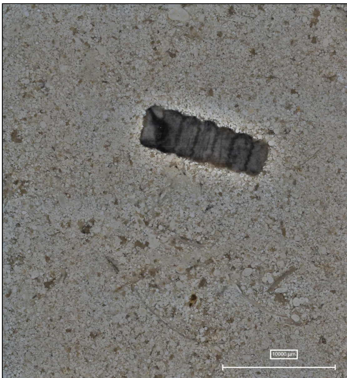
Figura 5: Análise macroscópica da superfície do provete do calcário: detalhe de microfóssil alongado e segmentado.
