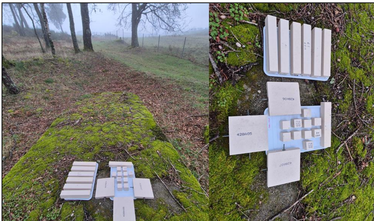
Figura 9: Ensaio de envelhecimento natural na Serra da Estrela: exposição das amostras aos agentes atmosféricos reais para recolha de dados meteorológicos.
