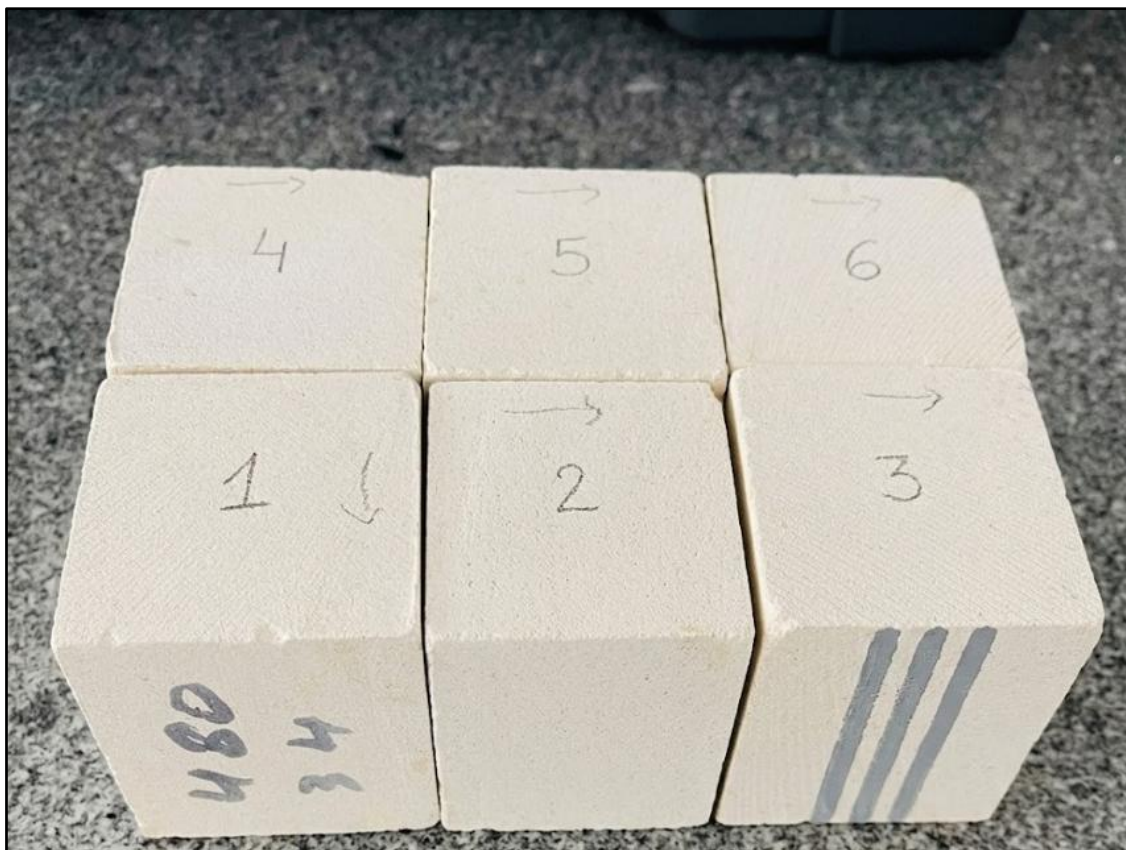
Figura 3: Amostras representativas do Calcário Branco Estremenho selecionado para o estudo.
