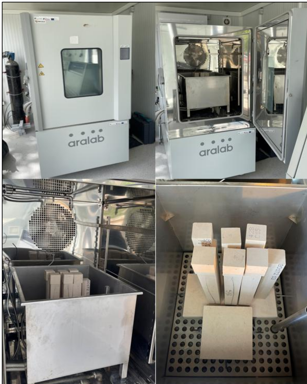
Figura 11: Câmara climática utilizada nos ensaios de envelhecimento acelerado.
