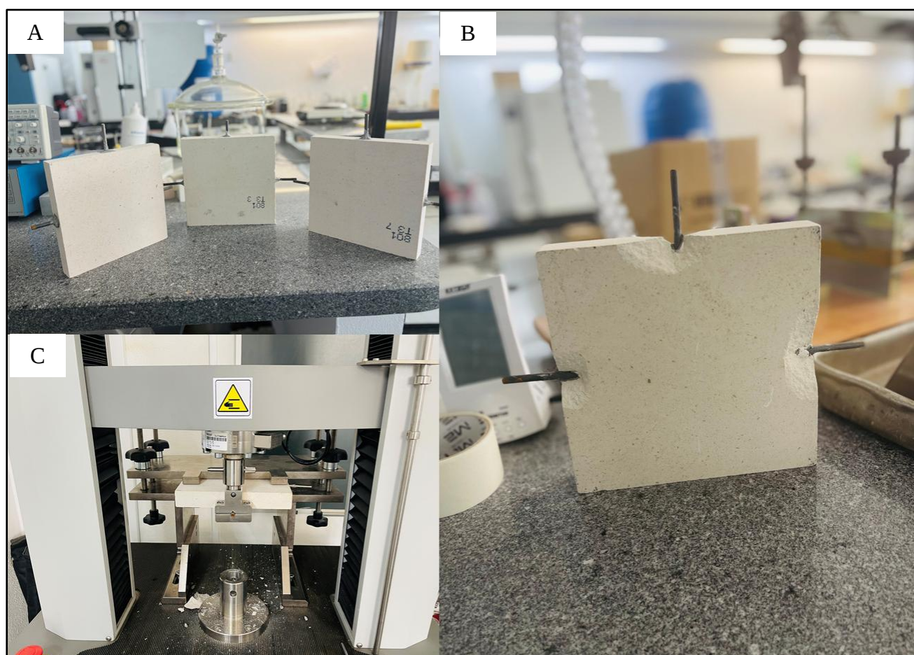
Figura 17: Ensaio de fixação mecânica por ancoragem: (A) placas de calcário preparadas com as cavilhas metálicas de fixação inseridas nos orifícios; (B) detalhe do modo de falha macroscópico na zona envolvente do orifício, evidenciando o lascamento troncocónico da pedra após a rotura; (C) montagem do ensaio na prensa, com dispositivo mecânico posicionado para aplicar a carga perpendicular ao eixo da cavilha.
