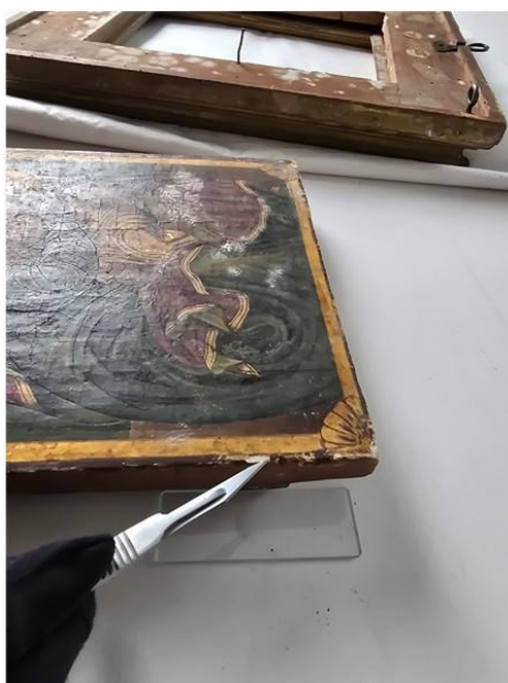
Figura 2.7: Microamostra do suporte da pintura 1252 para análise FEG-SEM
