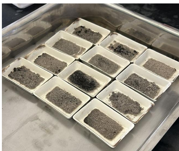
Figura 10: Amostras queimadas antes de serem colocadas na mufla
