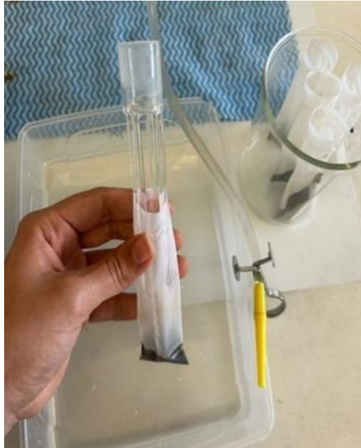
Figura 1711: Lavagem dos separadores
