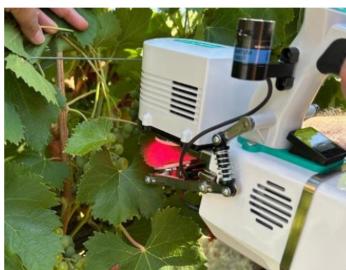
Figura 18 - Posicionamento do IRGA LI-6800 para medição das trocas gasosas em folhas do terço médio do sarmento
