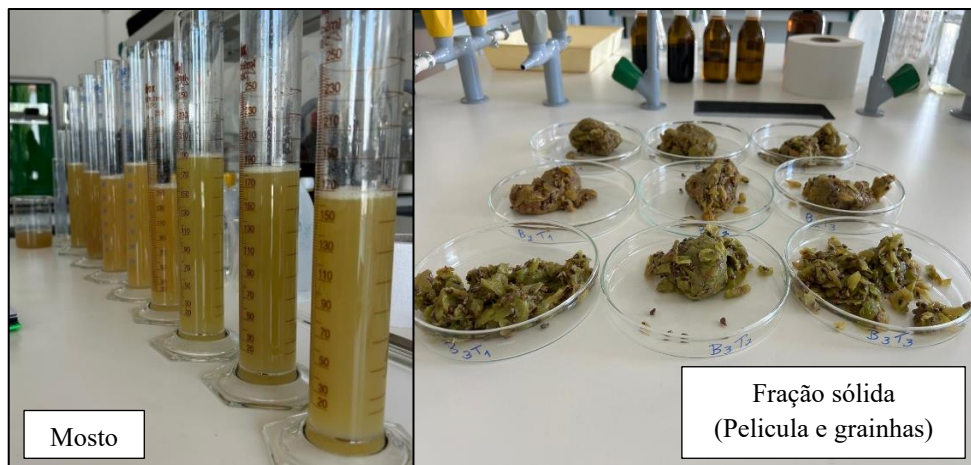
Figura 21 - Processamento laboratorial das amostras: mosto filtrado recolhido em provetas graduadas (esquerda) e fração sólida (películas e grainhas) pesada em placas de Petri previamente taradas (direita)
