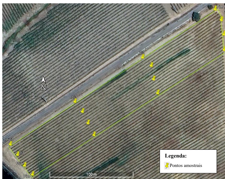
Figura 12 - Distribuição dos pontos de medição do débito dos gotejadores na parcela experimental da casta Antão Vaz
