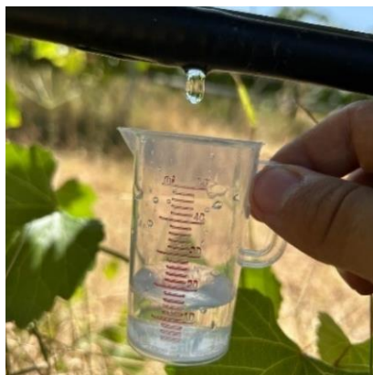
Figura 13 - Medição do débito do gotejador com copo medidor graduado
