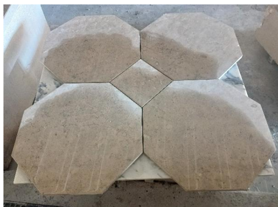
Figura 3.23: Exemplo de peças octogonais cortadas nas máquinas CNC.
