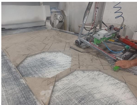
Figura 4.11: Remoção das peças cortadas através de uma ventosa acoplada a uma ponte rolante ou grua bandeira.
