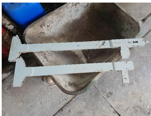
Figura 3.6: Tirantes e chavetas utilizados na montagem de lâminas nos engenhos multilâminas.
