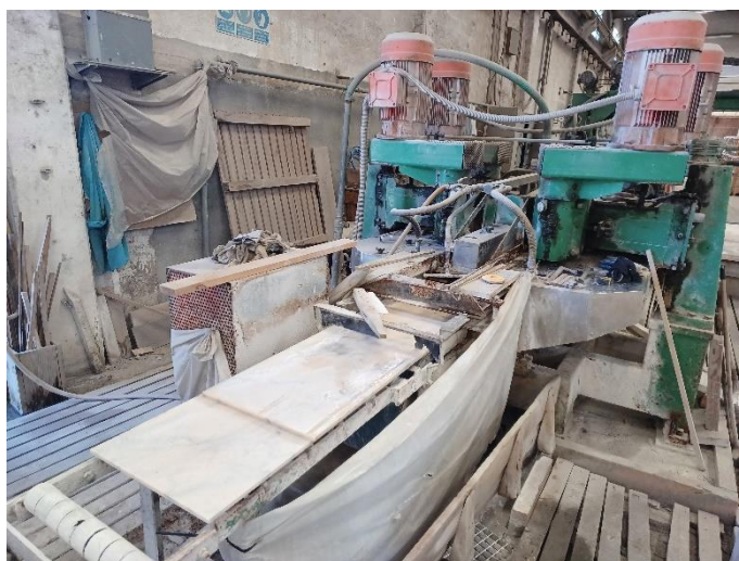
Figura 3.10: Refiadora em funcionamento, é possível visualizar a saída de duas bandas. Existem quatro motores, um para cada disco que corta horizontalmente as bandas.
