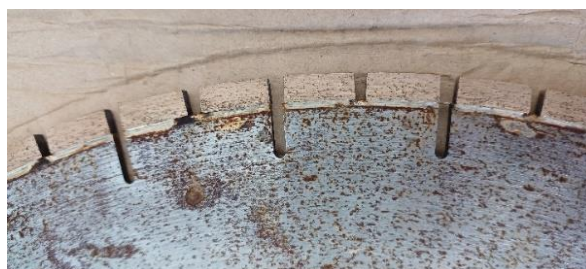
Figura 3.26: Exemplo de segmentos diamantados utilizados para o corte de mármore e rochas similares.
