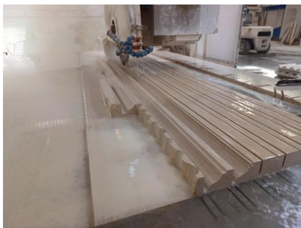
Figura 3.24: Máquina CNC em trabalho de perfilagem de peças.
