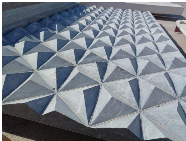
Figura 5.7: Peça B (baixo relevo a ser aplicado em fachada).
