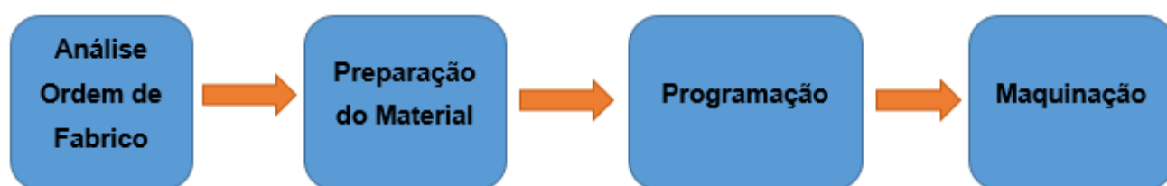
Figura 5.5: Encadeamento das tarefas principais a desenvolver no processo de produção com máquinas CNC.
