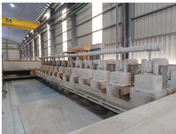
Figura 3.22: Doze cabeças equipadas com calços de amaciamento e polimento que dão o acabamento desejado a cada chapa.
