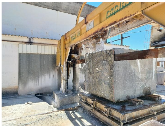
Figura 3.2: Monolâmina retirando uma face irregular indesejável de um bloco, de modo a aumentar o rendimento da serragem.
