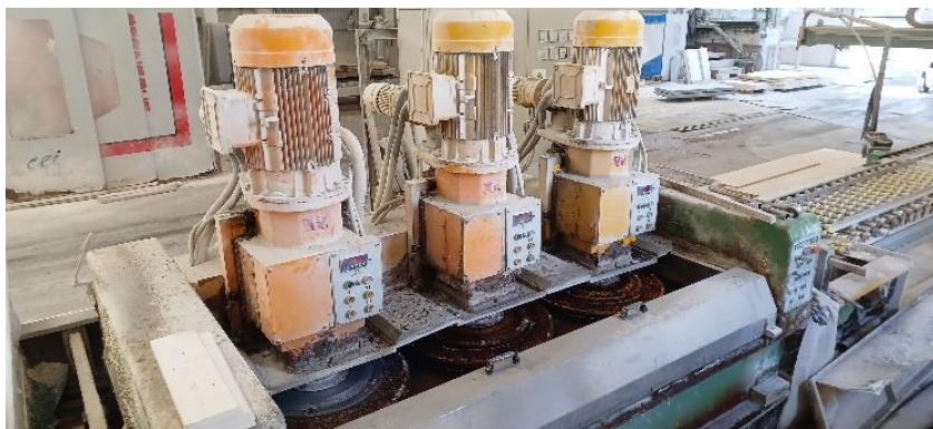
Figura 3.11: Três cabeças de calibração equipadas com pratos calibradores munidos de segmentos diamantados.
