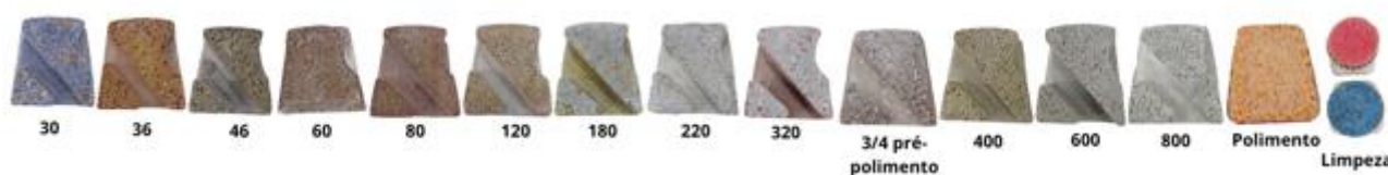
Figura 3.14: Sequência de calços utilizados no amaciamento e polimento de rochas ornamentais.
