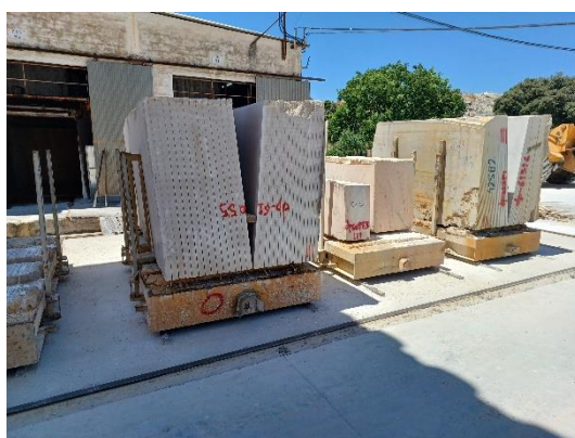
Figura 3.5: Zorras com blocos serrados em chapa e uma outra já carregada com dois blocos prontos a entrar para serragem.
