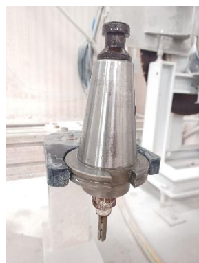
Figura 4.5: Cone de fixação de ferramentas (esquerda) ao motor das Máquinas CNC (direita).
