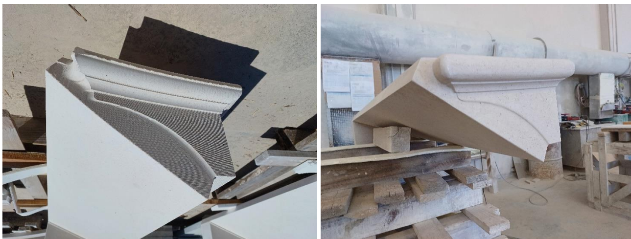
Figura 5.1: Nível de acabamento obtido na máquina (esquerda) e após o acabamento manual (direita).
