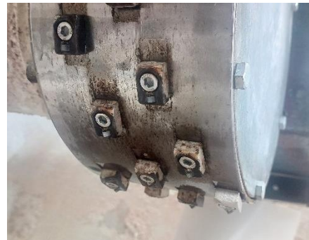
Figura 2.32: Fresa circular com dentes de tungstênio para realizar o acabamento riscado.
