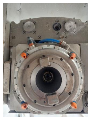
Figura 4.5: Cone de fixação de ferramentas (esquerda) ao motor das Máquinas CNC (direita).
