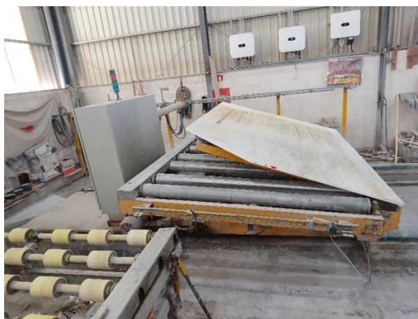
Figura 3.20: Chapa a ser dirigida por um carregador automático para iniciar o processo de polimento.
