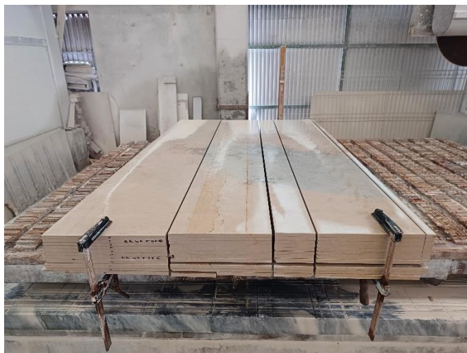
Figura 3.8: Chapas cortadas em bandas para, posteriormente, seguirem para a linha de ladrilhos.
