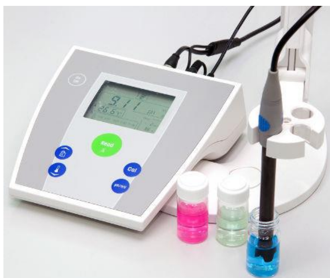
Figura 4: Medidor de pH (Fonte: Prolab, 2018)
