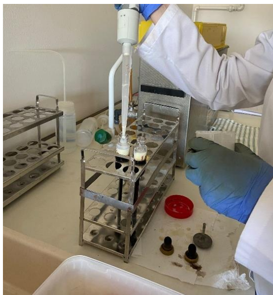
Figura 9: Adição da restante amostra no butirómetro (Fonte: Própria)
