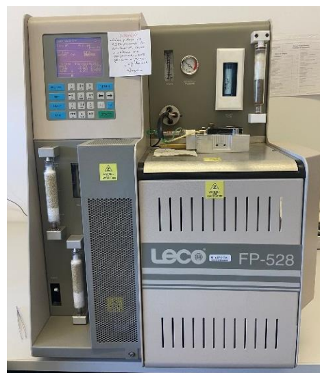
Figura 7: Figura 8: Leco, instrumento de leitura de proteína bruta (Fonte: Própria)
