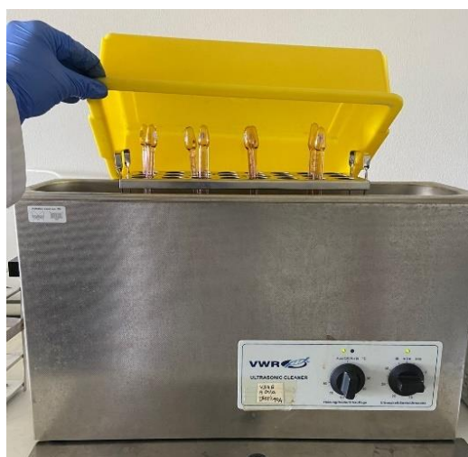
Figura 10: Colocação de um recipiente sobre as amostras de forma a não solidificar as mesmas (Fonte: Própria)
