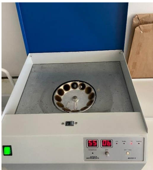
Figura 11: Butirômetros dentro da centrífuga (Fonte: Própria)
