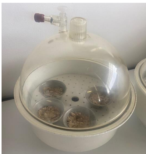
Figura 6: Cadinhos a arrefecer no exsicador (Fonte: Própria)
