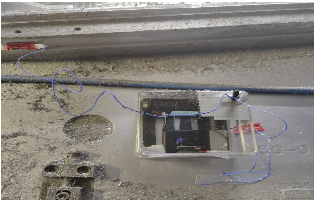
Figura 14 - Caixa do Termopar e ESP32-CAM acoplados na máquina
