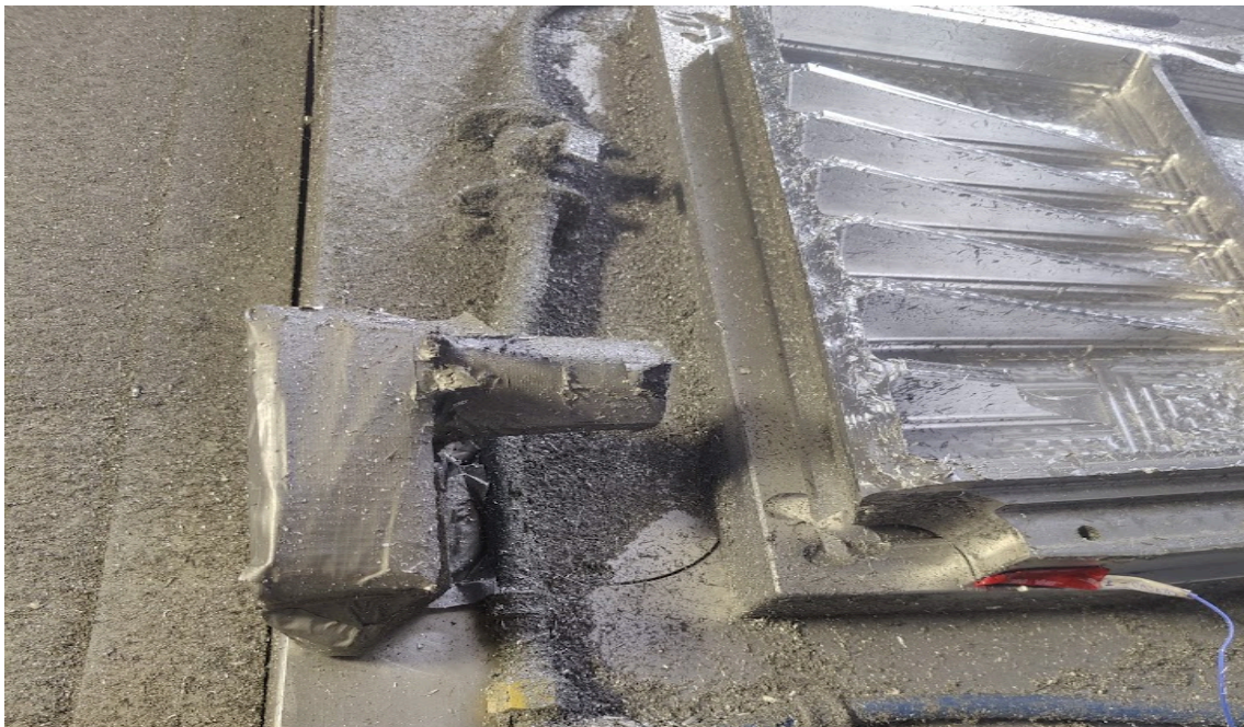
Figura 15 - Caixa do Sensor de Temperatura IR MLX90614 Acoplados na Máquina.
