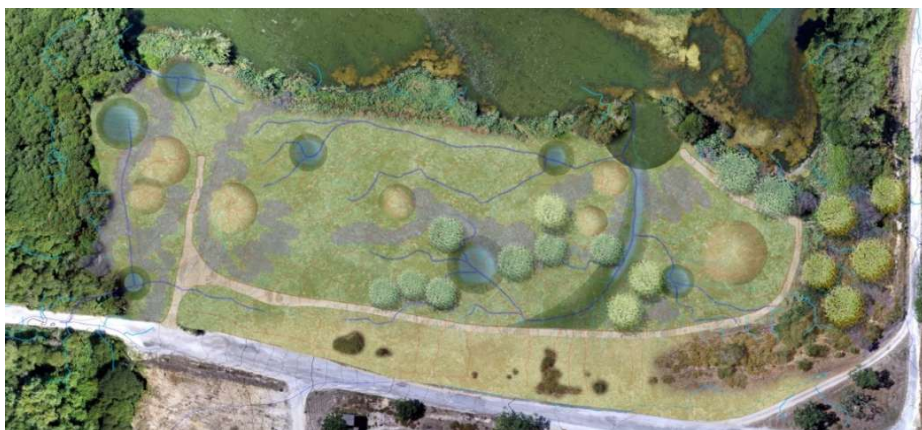
Figura 41. Localização de charcas de retenção, infiltração nas escorrências e aproveitamento do volume de escavação para evidenciar os pontos e linhas de cota mais alta.
