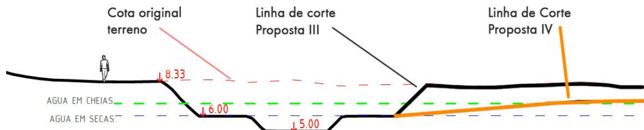
Figura 61. Corte tipo, em laranja: Mudança da cota seca
