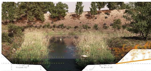
Figura 63. Corte tipo da proposta III. Em laranja: linha de terra da proposta IV.
