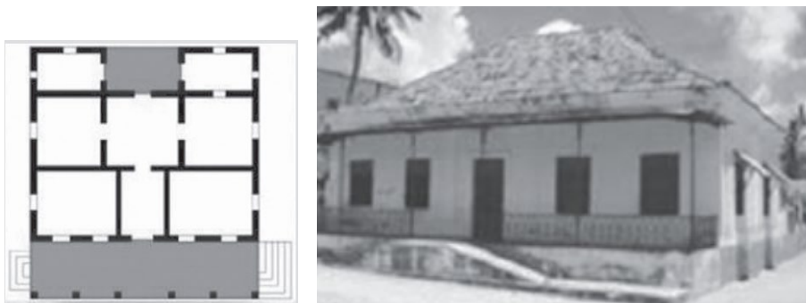
Figura 1 e Figura 2 – Casa de pedra e cal, com influência da casa swahili, localizada na ilha do Ibo. Os elementos de derivação swahili são reconhecíveis nas portas e janelas, fachadas elevadas, veranda e no telhado de quatro águas com solução para protecção solar e ventilação natural (Fonte: Carrilho, Bruschi, Meneses & Lage, 2004; Desenho e fotografia: Júlio Carrilho).
