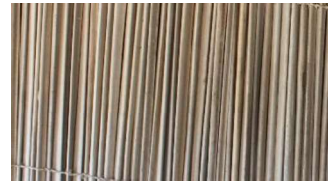
Pecíolo de palmeira para revestimento das portas
