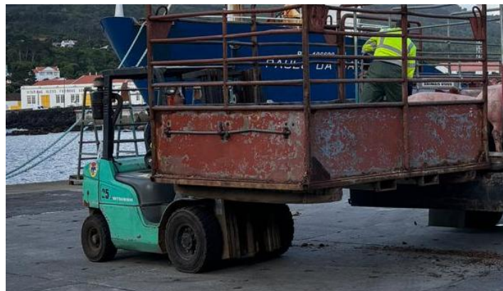
Figura 21: Içar de um contendor para o transporte rodoviário pela empilhadora (Fonte: Própria, 2024)
