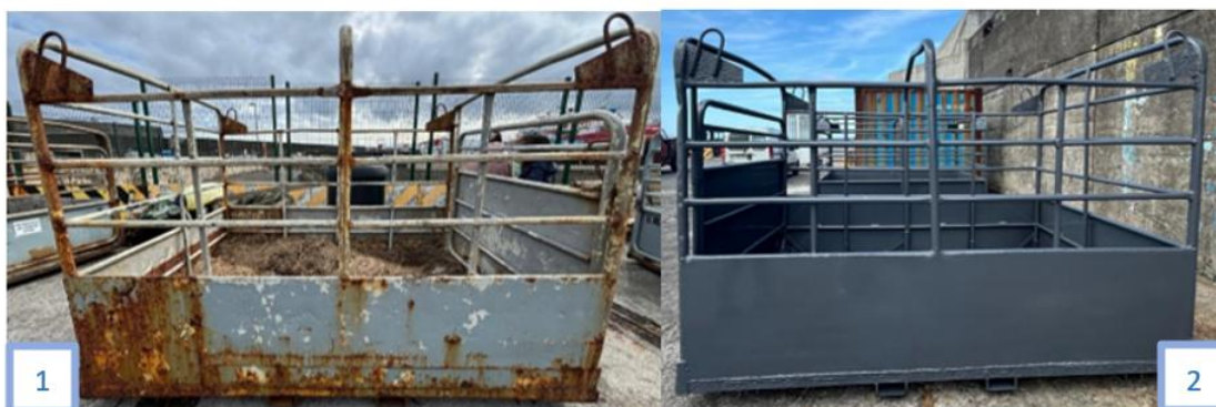
Figura 19: Antes (1) e depois (2) de um contentor de transporte para transporte marítimo de animais vivos (Fonte: Própria, 2024)
