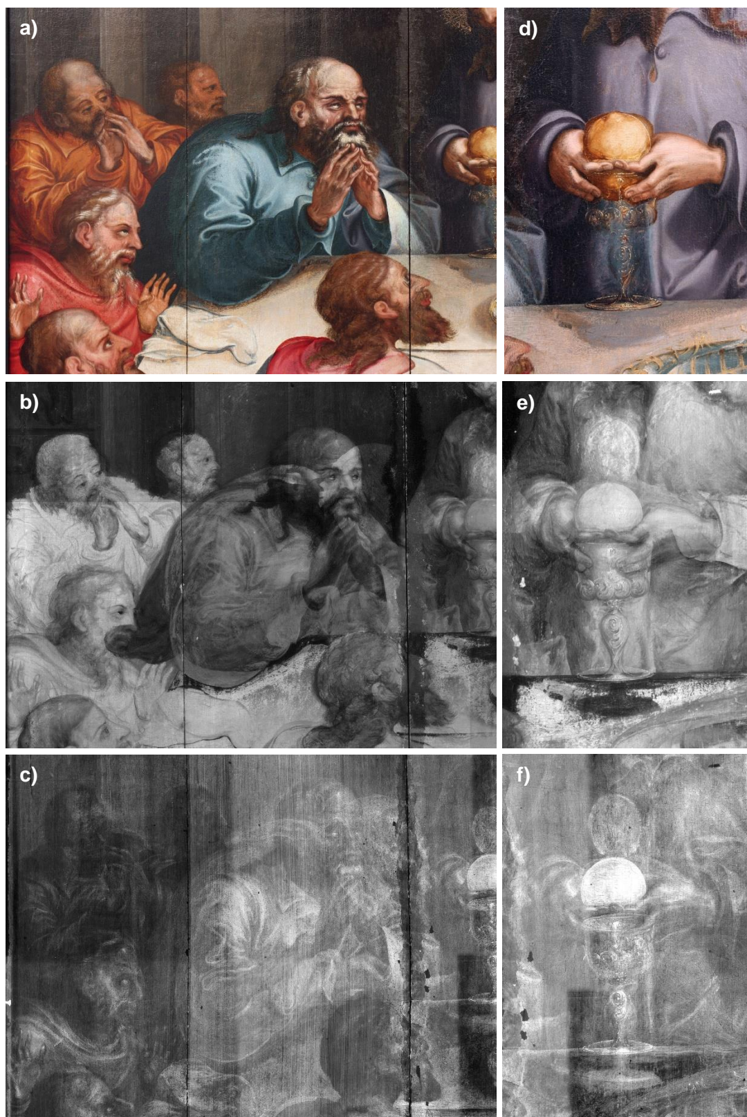
Figura 6.23 – Última Ceia (MASS, Évora), pormenores: a) e d) fotografia com luz normal; b) e e) reflectografia de infravermelho; c) e f) radiografia.
