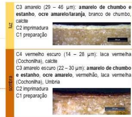
Figura 7.9 - Última Ceia (c. 1565-1570): estratigrafia e composição de zonas onde se verifica o predomínio de pigmentos amarelos – amarelo de chumbo e estanho, ocre.
