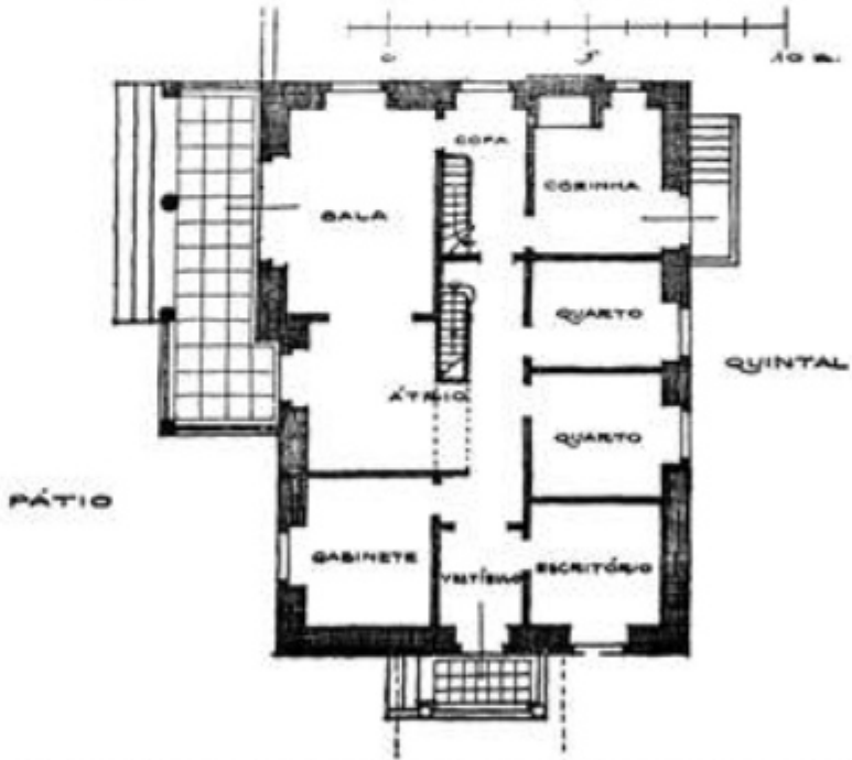
21. CASA NUMA CIDADE DO ALGARVE — Suprimida alguma cantaria e substituído o alpendre por tabuleiro de cimento armado, logo teríamos casa à moda actual. Não víamos nisso porém apreciável vantagem — técnica, económica ou sentimental.
