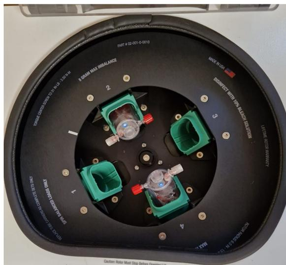
Figura 22 - Centrifugadora usada para a preparação da solução de proteína autóloga. (Fotografia cedida por colega Ana Tareco)
