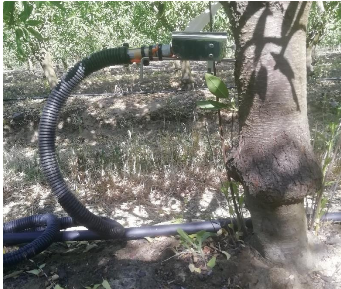
Figura 3.14 – Dendrómetro instalado no tronco de uma amendoeira.
