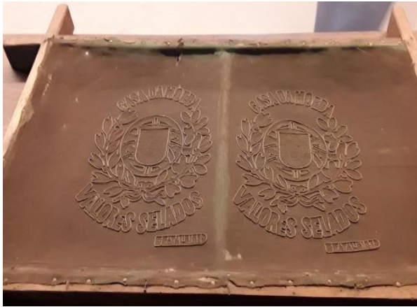
Fig.17: Molde de madeira, formado por uma teia metálica, onde era cosida a filigrana que daria origem à marca de água posterior que neste caso se constituía por duas formas em simultâneo.
