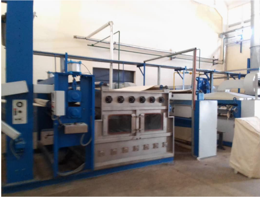
Photo 32 : Machine à émeriser le tissu lors de la production du textile de la NSTT
