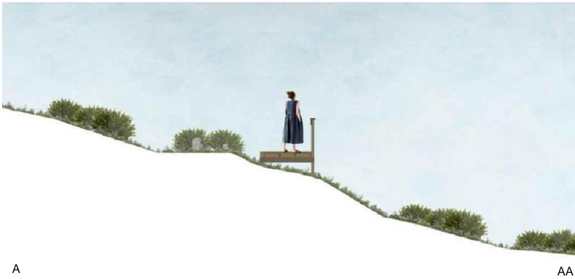
Figura 99. Corte-alçado da proposta de Integração Paisagística para o Planalto do Escarpão. A estrutura é composta por madeira Carmo Wood, baseada no passadiço – guarda tipo G3, G4, G5 (sem escala).
