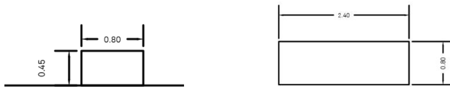
Figura 69. Banco – especificação técnica. Corte-alçado com medidas (metros).
