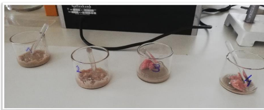
Figura 5 - Homogeneização das amostras com areia e etanol. (Autoria própria)
