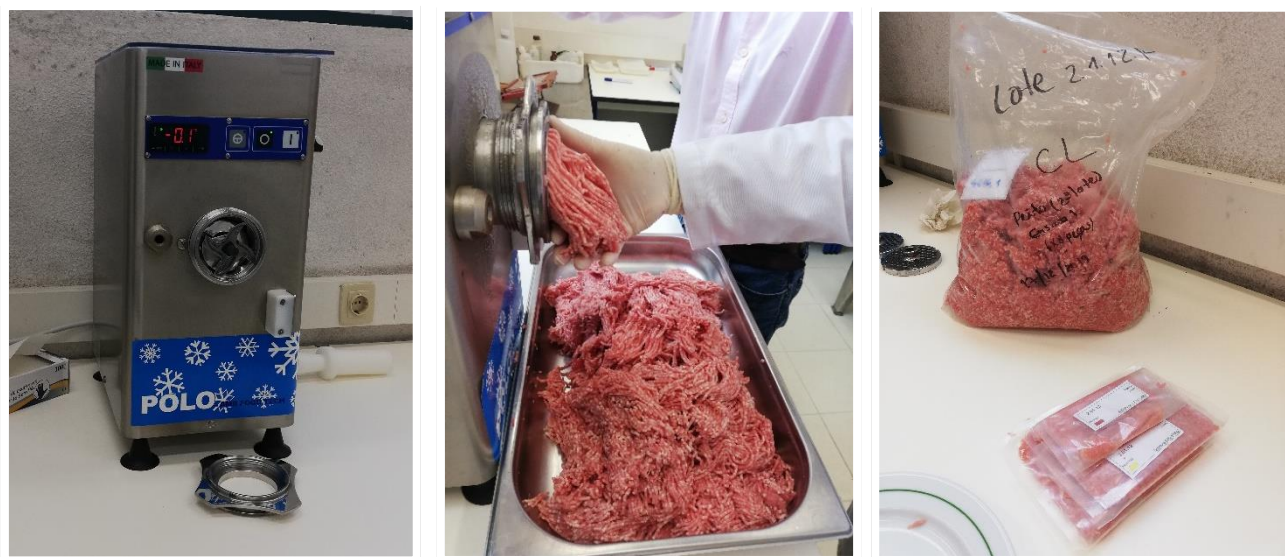
Figura 2 - Preparação das amostras numa picadora contínua refrigerada e posteriormente embaladas em sacos. (Autoria Própria)
