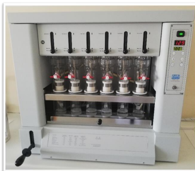
Figura 8 - Extrator de laboratório de Soxhlet SER 148 series, em funcionamento (Autoria própria)
