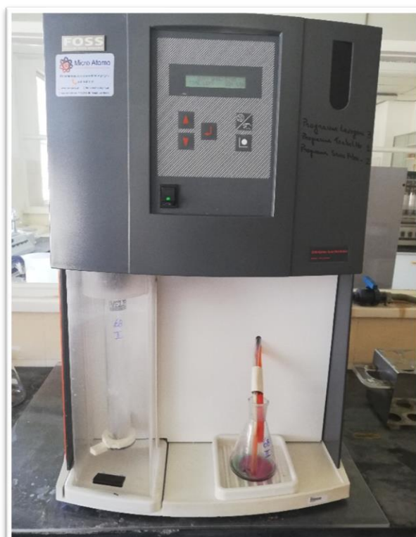
Figura 6 - Aparelho 2200 Kjeltec Auto Distillation em funcionamento (Autoria própria)
