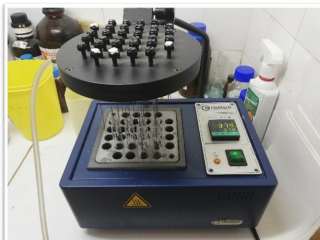
Figura 9 - Evaporação do solvente por meio de corrente de azoto (Autoria própria)
