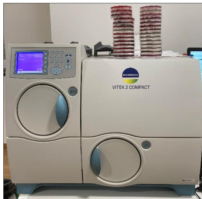
Figura 7 - Sistema de identificação microbiológica e realização de testes de sensibilidade antimicrobiana, VITEK® 2 Compact (bioMérieux, Inc. Hazelwood, MO). Fotografia original da autora captada durante o estágio no L.V. INNO.
