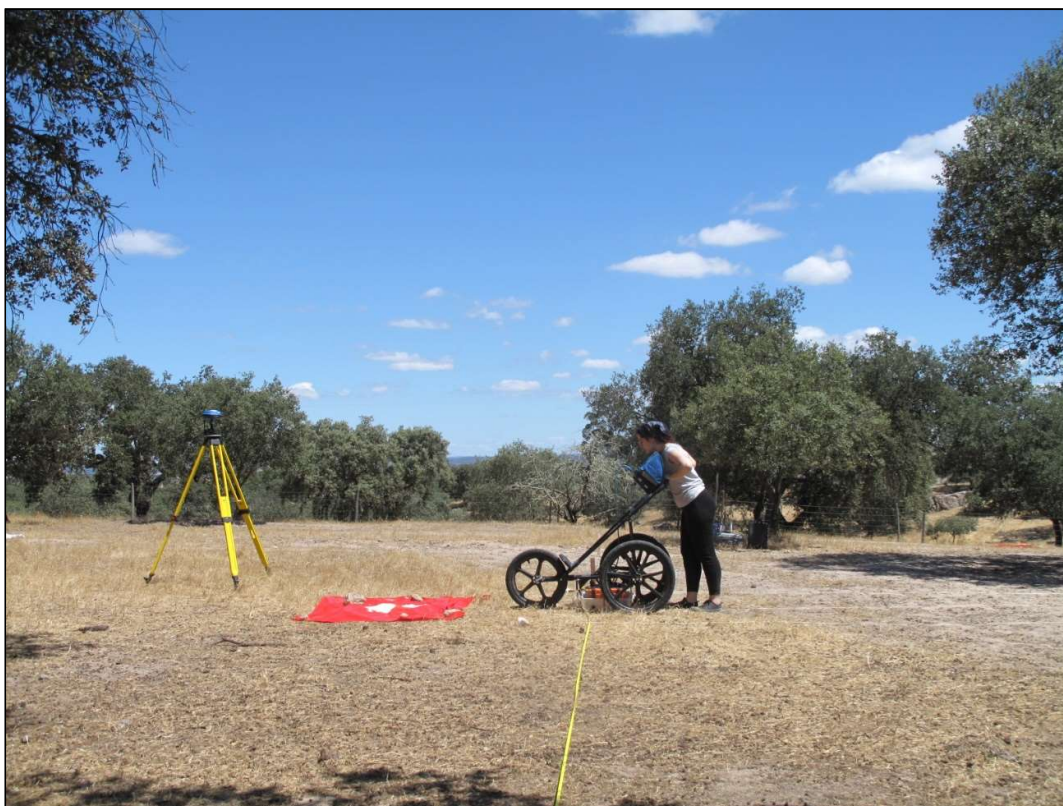
Figura 12: Aquisição de dados com georradar na campanha de 2019.
