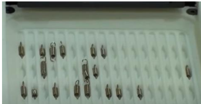
Figura 36 - Estrutura da plataforma do flexfeeder para molas (source [8])
