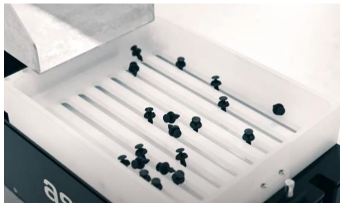
Figura 37 - Exemplo de plataforma para rebites de plástico (source [8])
