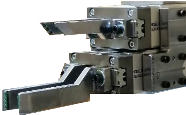
Figura 33 - Pinças novas, alinhadas com a flange
