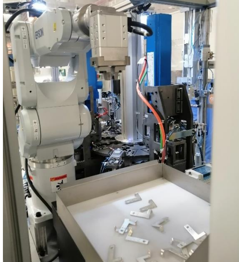
Figura 54 - Fotografia da máquina M155 com um flexfeeder
