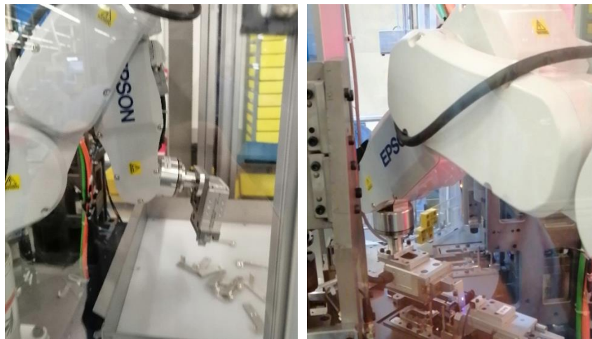
Figura 55 - Robô na zona do flexfeeder e outra na zona de inserção
