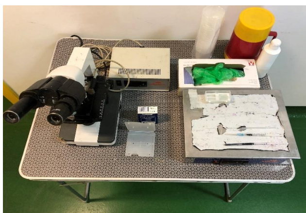
Figura 12 – Material utilizado em situação de campo (microscópio com platina aquecida, placa de aquecimento, laminas, lamelas, solução salina e coloração de eosina-nigrosina) (Fotografia do Autor)
