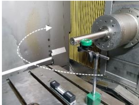
Figura 2.4-7 Segunda leitura com a barra padrão.
