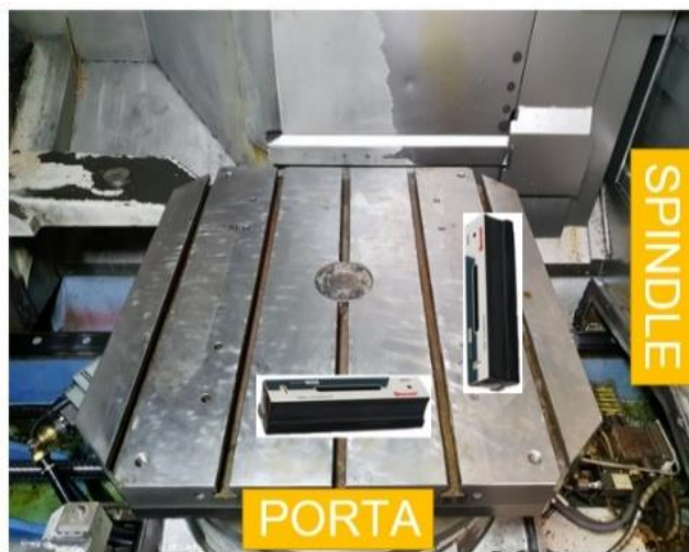
Figura 2.4-3 Posicionamento dos níveis na mesa de trabalho.
