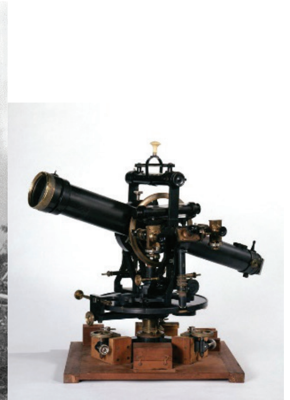
Um dos teodolitos Salmoiraghi pertencente à coleção de equipamentos científicos do IICT, que possuía quatro teodolitos comprados sob recomendação de Gago Coutinho, para usar na Missão Geodésica da África Oriental e posteriormente na Missão Geodésica a São Tomé e Príncipe, nos trabalhos de triangulação e astronomia – objeto integrado na coleção do MUHNAC. Instituto de Investigação Científica Tropical © ULisboa/IICT.
