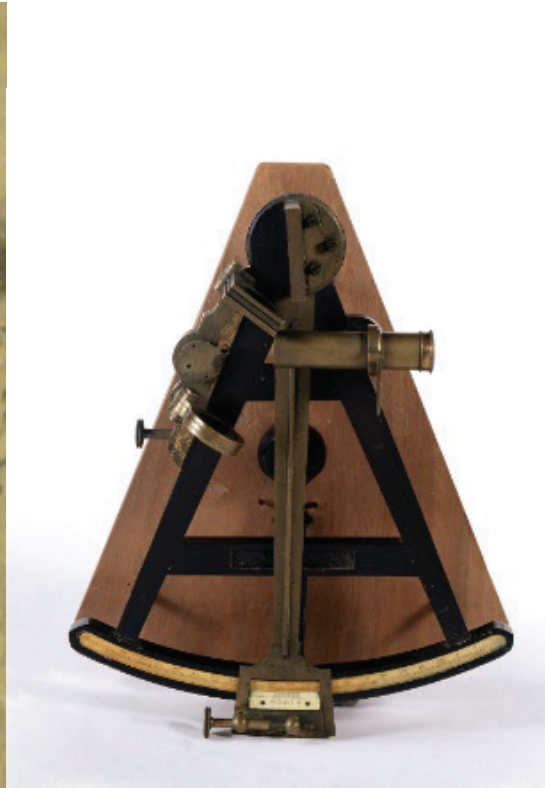
Sextante pertencente à coleção de equipamentos científicos do IICT, usado nos trabalhos de medição de ângulos durante as Missões Científicas nos Trópicos. Instituto de Investigação Científica Tropical © ULisboa/IICT.
