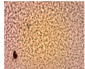
Figura 3.23 - Superfície da película de quitosano 1.5% + ácido acético 0.5% + Tween80 ® + Eugenol; ampliação de 40x
