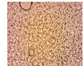
Figura 3.19 - Superfície da película de quitosano 1% + ácido acético 0.5% + Tween80 ® + Mentol + Eugenol; ampliação de 40x
