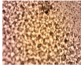
Figura 3.21 - Superfície da película de quitosano 1.5% + ácido acético 0.5% + Tween80 ® ; ampliação de 40x
