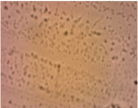
Figura 3.20 - Superfície da película de quitosano 1.5% + ácido acético 0.5%; ampliação de 40x
