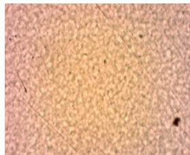
Figura 3.17 - Superfície da película de quitosano 1% + ácido acético 0.5% + Tween80 ® + Mentol; ampliação de 40x
